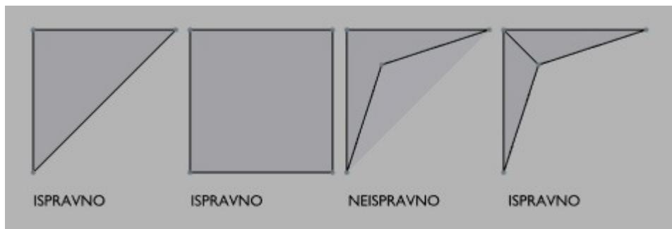
Poligoni mogu da budu trouglovi ili četvorouglovi koji nisu konkavnog oblika. Poligone sa više od 4 tačke ne smete imati u realizaciji ovog zadatka. U slučaju četvorougla konkavnog oblika neophodno je četvorougao promeniti u 2 trougla, da bi se izbegao problem lošeg senčenja geometrije.
