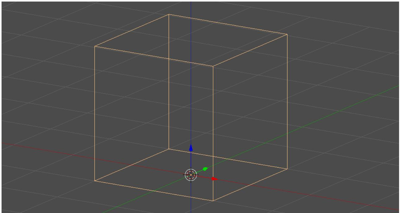
Centar transformacija objekta (pivot) treba da se nalazi u dnu objekta, približno na sredini dna. Pozicija objekta (pivota) treba da bude na 0,0,0 u odnosu na koordinatni sistem scene. Rotiranost objekta (pivota) treba da bude na 0,0,0. Skaliranost objekta (pivota) treba da bude 100%, 100%, 100%.
